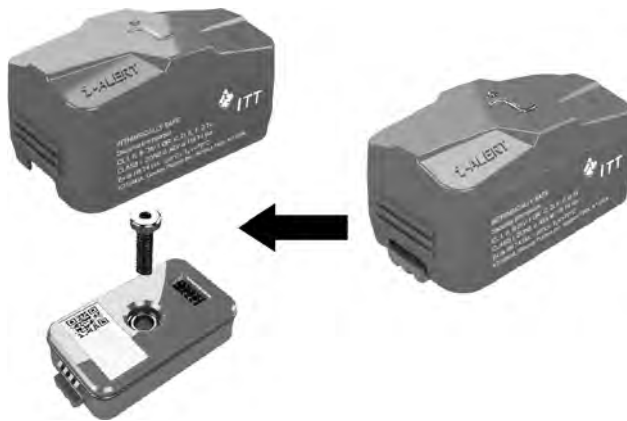
Afbeeldingnr. 43: Neem de batterij van de sensor als de pomp gedurende een langere periode buiten gebruik is
